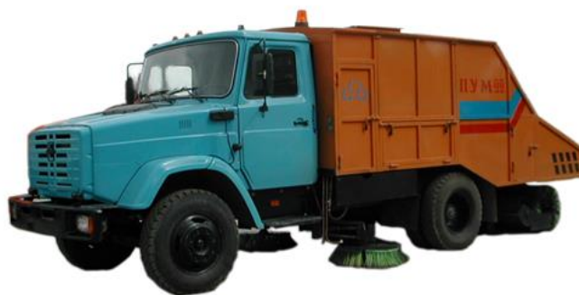
Рисунок 6.3 - Подметально-уборочная машина ПУМ-99 (ЗиЛ-433362)
