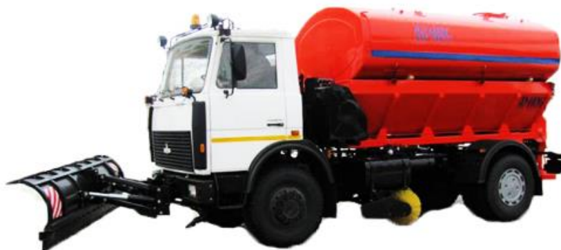
Рисунок 6.4 - Комбинированная машина КО-713А-40 на базе МАЗ-438043
