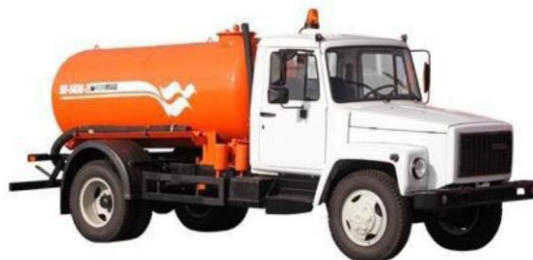
Рисунок 5.2.1 - Вакуумная машина КО-503В-2 на шасси ГАЗ-3309
